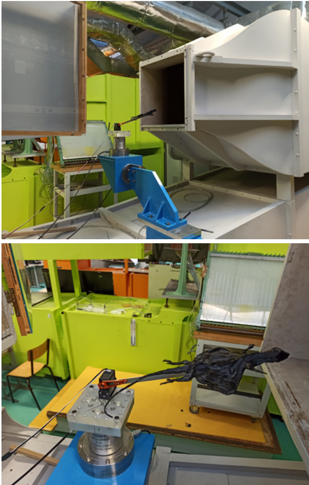
Figure 3 : Soufflerie de l'IUT de Ville-d'Avray et mesures d'efforts sur balance 6 axes
